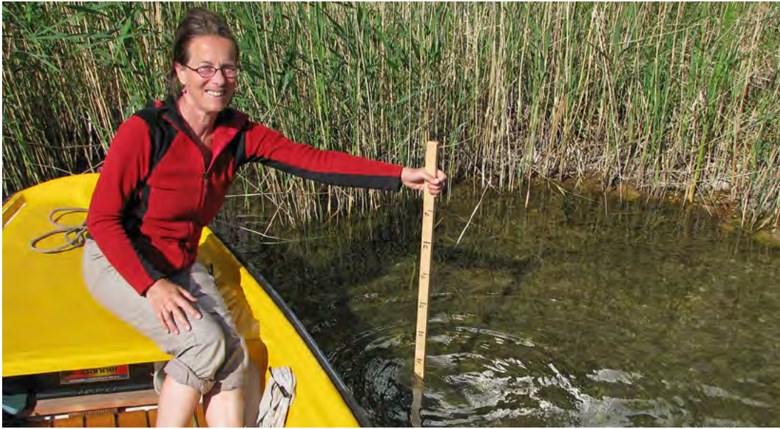
Methodik im Freiland: Mittels einer Messlatte wurden die Wassertiefen in und vor der Ufervegetation gemessen.
